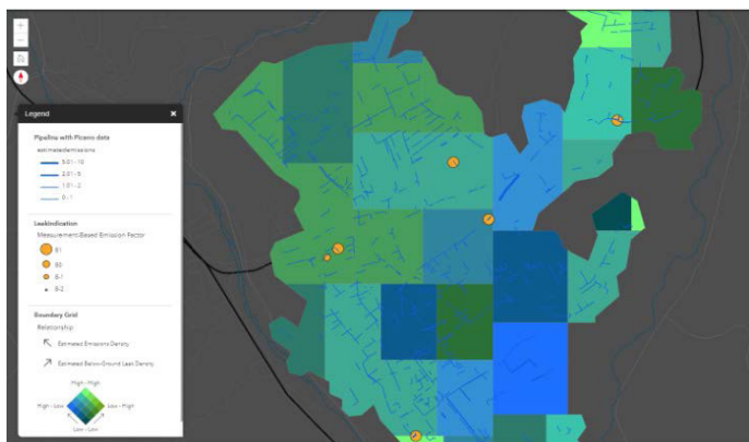
Abbildung 4. Das NAV-Bild zeigt eine Darstellung der Emissionsdichte im Verhältnis zur Leckdichte, wobei hochemittierende Punktquellen und Rohrleitungsabschnitte überlagert sind. NAV ermöglicht eine schnelle Analyse komplexer Daten, um fundierte Entscheidungen über die Netzinfrastruktur treffen zu können.
